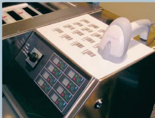
Сканер штрихкода гарантирует регистрацию фаз замораживания каждого контейнера с кровью. Его конструкция соответствует стандарту ISP 128
